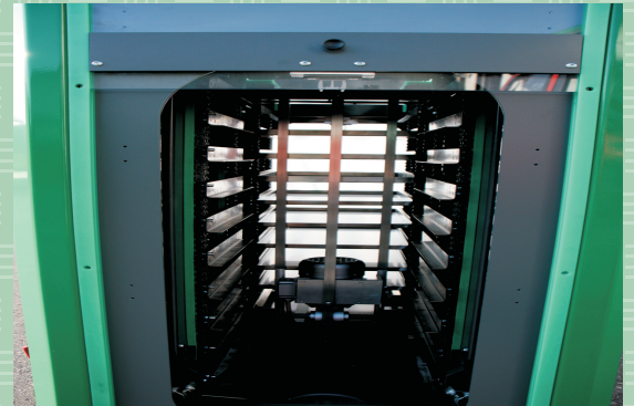
manuelle Beladung der einzelnen Paletten, auch während des Betriebes
